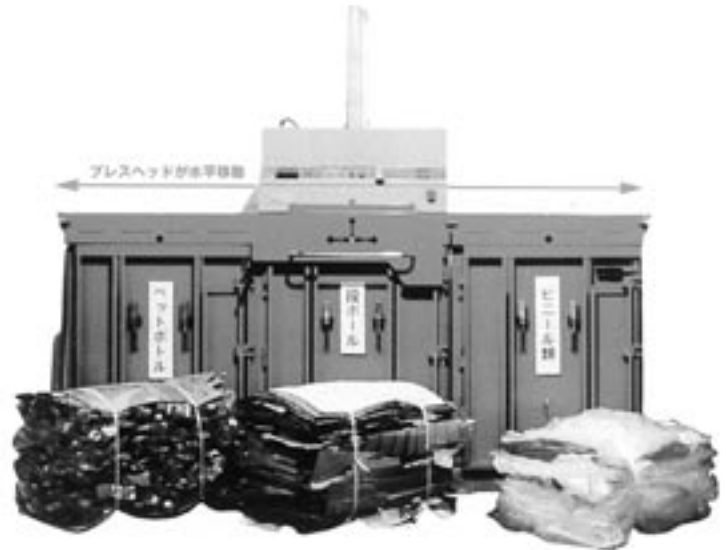
廃ビ・廃プラ圧縮機
